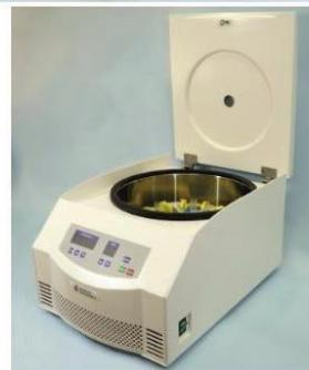
•Этап 4 - нанесение клеток на предметные стекла центрифугированием
