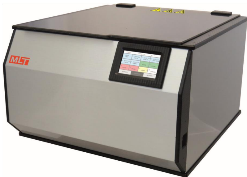
Рис. 3 Автомат окраски АФОМК-12-25 для цитологического скрининга по Папаниколау (производство ООО МЛТ ОЭЗ ТВТ «ДУБНА»)
